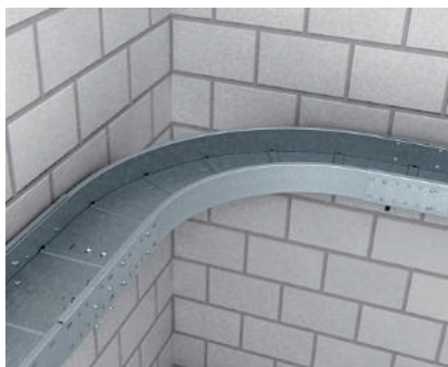
Montáž oblouku 90° Oblouk v kombinaci s kabelovými žlaby pro velká rozpětí. Oblouk se spojuje pomocí vnějších spojek a spojovacích lišt s kabelovým žlabem pro velká rozpětí.
