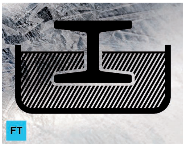
Žárové zinkování ponorem podle normy EN ISO 1461
