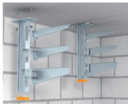
Montáž výložníků Montáž 3 úrovněového kabelového nosného systému pod betonový strop použitím závěsných výložníků AS 15, AS 30 a AS 55.
